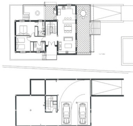
Grundriss vom Erdgeschoss und Keller
